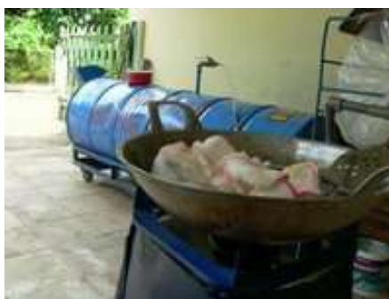
Gambar 5. Reaktor Biogas Yang Telah Dihubungkan Dengan Kompor Gas.
