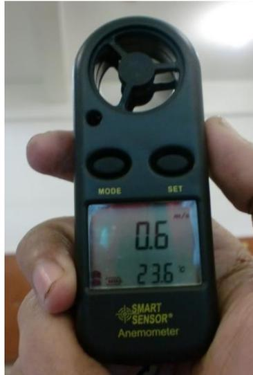
Gambar 2. Hand Anemometer
