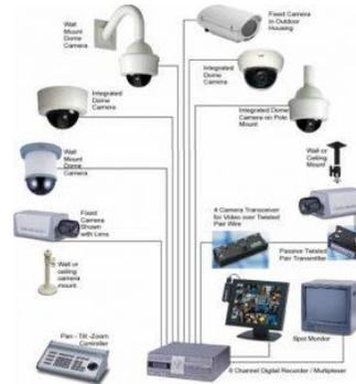
**Gambar 4.33** Sistem kerja cctv pada bangunan
