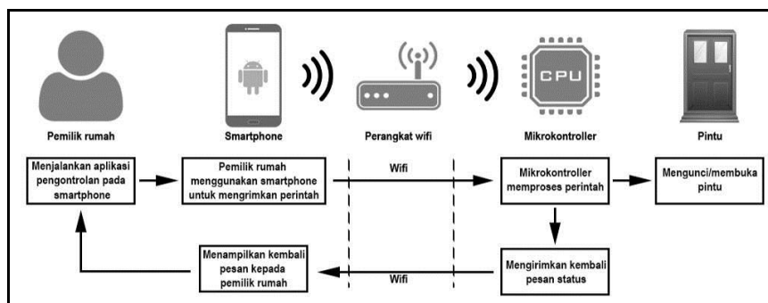
Gambar 3. Desain Arsitektur Sistem Penguncian Pintu
