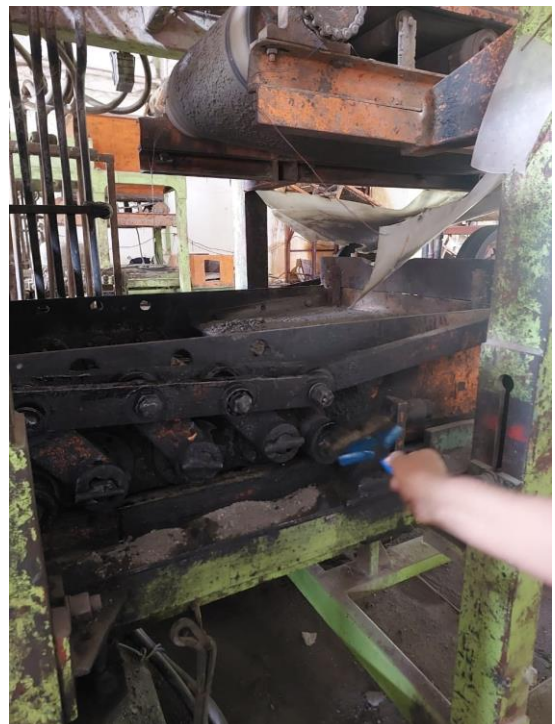
Proses Pelumasan Oli pada Howling Pemutar Kuku
