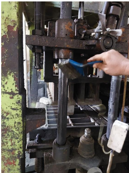
Proses Pelumasan Oli pada AS Press
